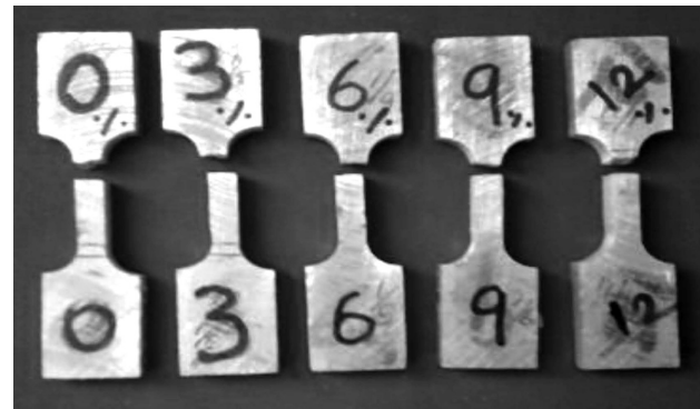
Figure 4: Photograph of tensile-tested specimen Slika 4: Posnetek izgleda nateznih preizkušancev
