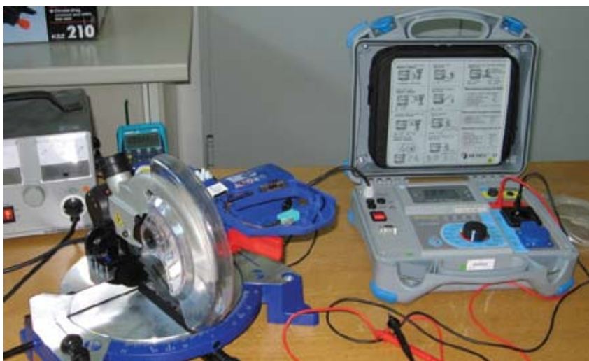
Slika 4: Preizkuse in meritve električne opreme se izvaja s standardizirano merilno opremo. (Foto: Ivan Božič)
