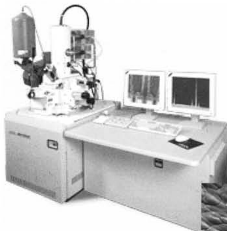
Elektronski mikroskop Jeol JSM-6500F opremljen z ED, WD in EBSD
