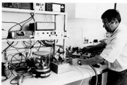
Tlačna tehnica RUSKA 2465A za kalibracije merilnikov tlaka
