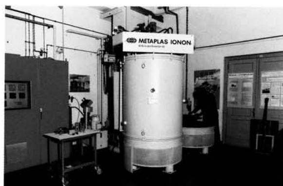
METAPLAS IONON HZIW 600/1000 peč za nitiranje v pulzirajoči plazmi
