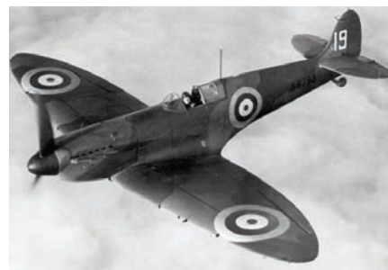
Zgodnji spitfire Mk.I iz prve predvojne serije z dvokrakim lesenim propelerjem v letu. Tovrstne oznake – številka na repu in štiribarvne kokarde na krilih – so kmalu prišle iz mode.
