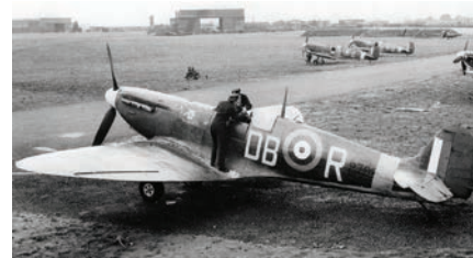
Kanadski spitfire Mk.IIa. Letalo je bilo na nekaterih mestih zelo obrabljeno, tako da se vidi gola kovina.
