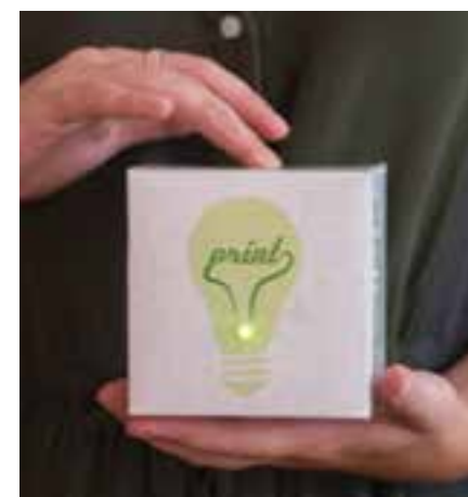
Slika 5: Aplikacija senzora na predstavitveno embalažo za prižig LED lučke Figure 5: Demonstration of sensor on packaging
