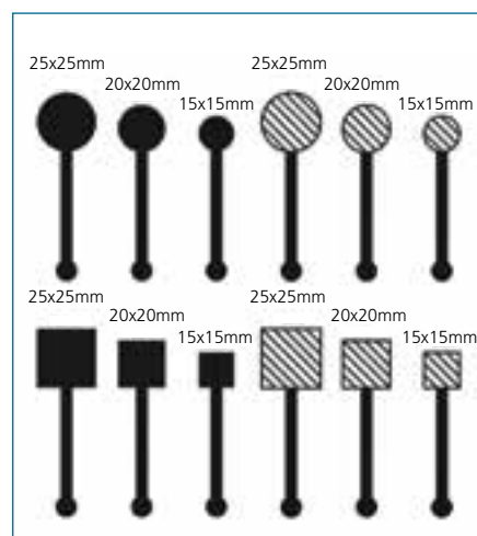
Slika 3: Elektrode različnih velikosti in oblik: levo – polne elektrode, desno – šrafirane elektrode Figure 3: Electrodes of different sizes and shapes: full electrodes (left) and electrodes with stripes (right)
