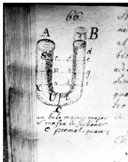
Slika 21: Huberjeva skica ravnovesja v kapljevini kot uvod k opisu vakuumskih črpalk (Huber, Philosophia Corporum , str. 66)
