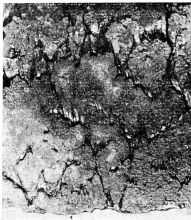
Slika 1 Videz raztrgane površine valjanca
