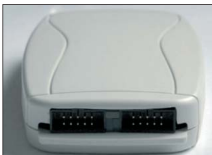
Slika 1. Sprednja stran vmesnika s podatkovnima vhodoma in LED-indikacijo aktivnega vhoda
