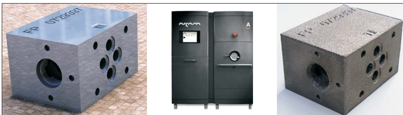
Slika 1. Kljub odličnemu realističnemu fotografskemu prikazu se nič ne more primerjati z modelom v roki. Levo: model ohišja CAD, sredina: naprava EBM (Electron Beam Melting), desno: ohišje ventila iz Ti6Al4V.
