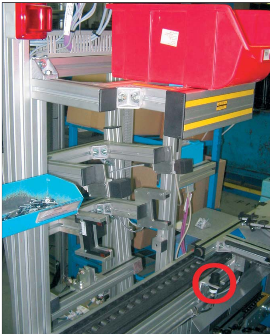
Slika 3. Senzorsko polje za preverjanje opreme in linijski čitalnik črtnih kod
