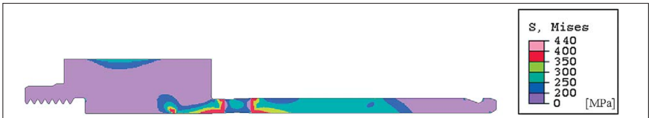
Slika 12. Ekvivalentne napetosti na celotnem jedru
