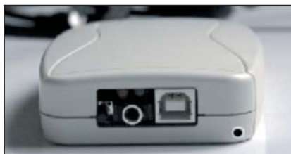
Slika 2. Zadnja stran vmesnika s priključki
