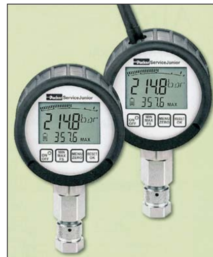
Digitalna merilnika tlaka SensoControl®ServiceJunior (levo) in brezžična inačica merilnika SensoControl®ServiceJunior wireless (desno)
