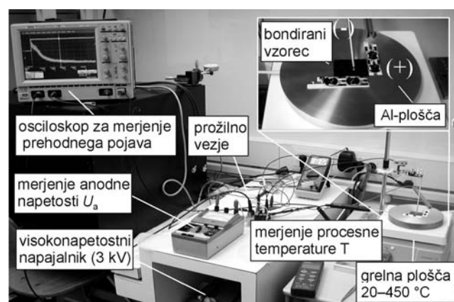
Slika 1: Postavitev merilnega okolja in sistema za izvajanje anodnega bondiranja
