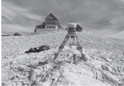
Slika 10: Signalizacija oslonilne točke in njena GPS-izmera v letu 2005. Foto: Matija Klanjšček in Blaž Barborič.
