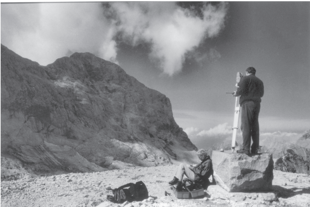
Slika 4: Tahimetrična izmera oboda ledenika ter oslonilnih in poligonskih točk v letu 1999. Foto: Iz osebne arhiva Franja Droleta.
