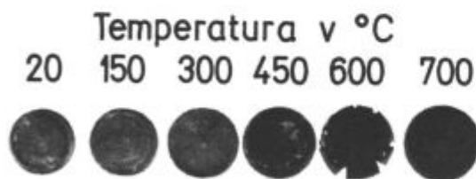
Slika 3 Površine valjčkov iz jekla Č.4650 po stiskanju pri različnih temperaturah Fig. 3 Surface of cylinders of Č.4650 steel after compression at various temperatures.
