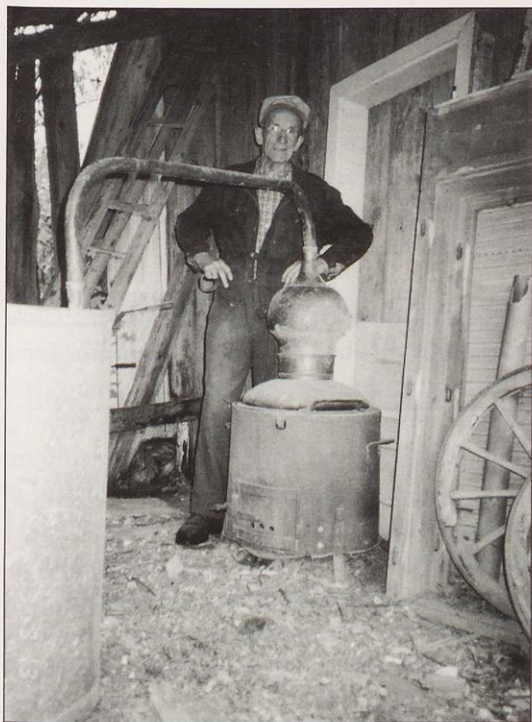
Jože Glad iz Ograje ob starem kotlu za kuhanje žganja z značilno ozko kapo in cevjo, speljano z vrha kotla.
