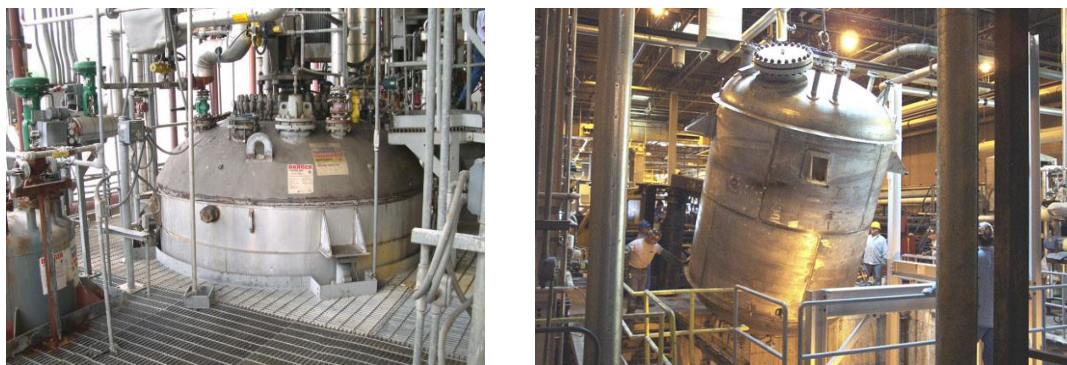
Slika 5.8: Šaržni reaktor v proizvodnji (Vir: splet).
