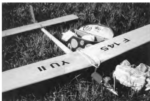
Model motornega letala, za katerega je bila namesto smrekovega lesa uporabljena balza (lahek les, lažji od smrekovine).
