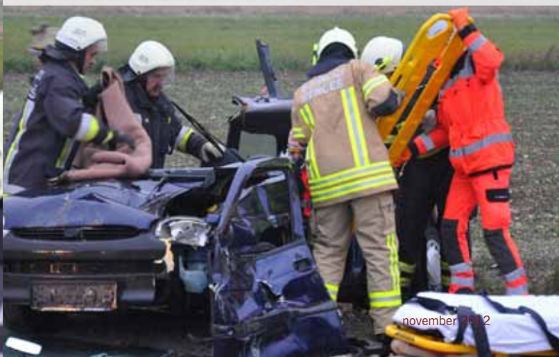
Gasilci so odstranili streho vozila, ter tako skupaj z reševalcem voznika varno namestili na zajemalna nosila
