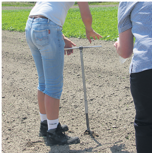
Foto: Miša Pušenjak Odvzem vzorca zemlje za analizo s sondo je najpravilnejši.
