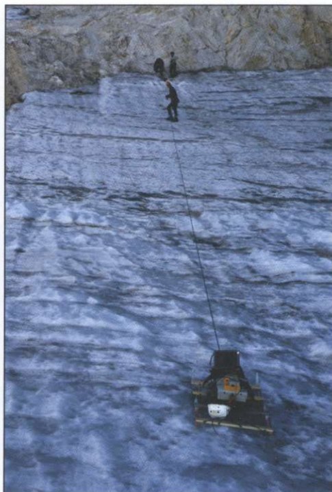
Prvič so bile z georadarjem opravljene meritve globine ledu. Na posameznih mestih je globina ledu od 7 do 8 m (foto: Milan Orožen Adamič).
