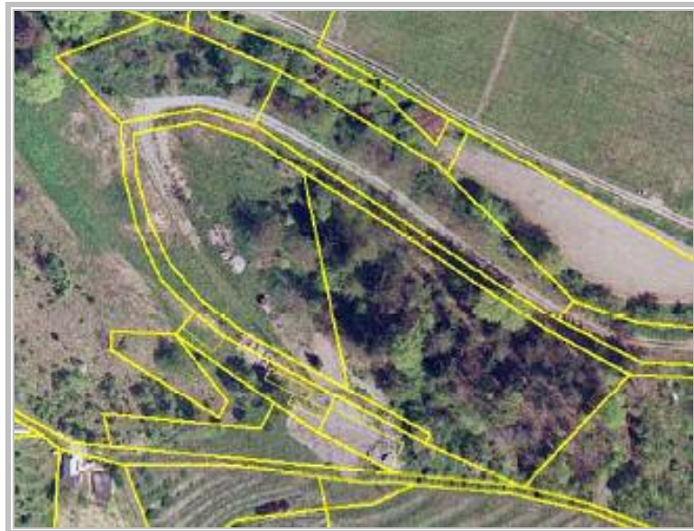
Slika 48: Osnova za določitev identičnih točk na digitalnem ortofotu in zemljiškokatastrskem prikazu Fig. 48: Basis for determination of identical points on a digital ortofoto and land cadastral graphical presentation
