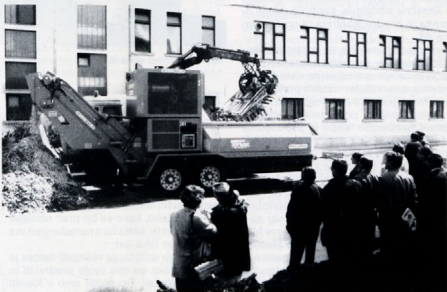
Strojna oprema za kompostiranje zajema stroj za drobljenje organskega materiala, ki zagotavlja kvalitetno izvedbo mešanja in drobljenja, obračalni stroj, ki zadovoljuje vsem zahtevam za uspešno kompostiranje, sejalni stroj, na katerem je mogoča hitra in enostavna menjava sit za sejanje na primer komposta, drobljene skorje, peska, proda, prsti. K omenjeni opremi sodi tudi traktor, s katerim opravljajo nakladanje, transport strojev in vso ostalo manipulacijo, služi pa tudi kot pogonski agregat predvsem obračalnemu stroju.
