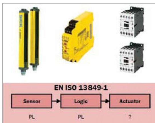
Določanje varnostne funkcije sistema SRP/CS
