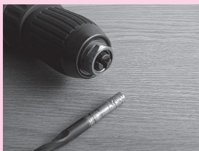
□ Slika 4. Uničeno steblo svedra in nepoškodovane čeljusti vpenjalne glave
