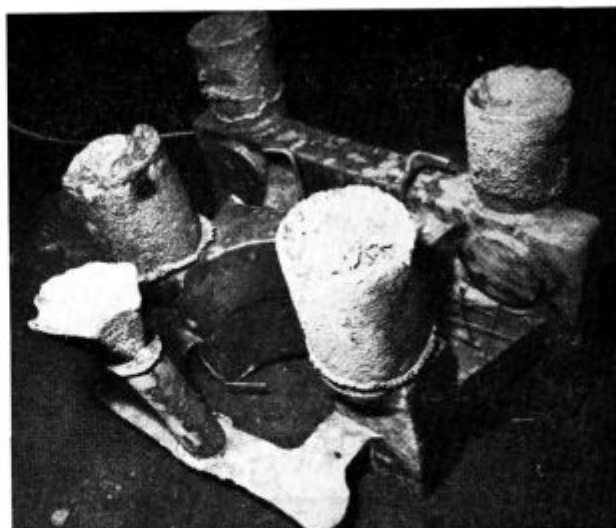
Teža vlivnega in napajalnega sistema 68 kg
