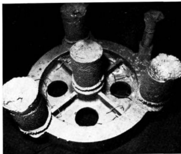
Teža vlivnega in napajalnega sistema 63 kg
