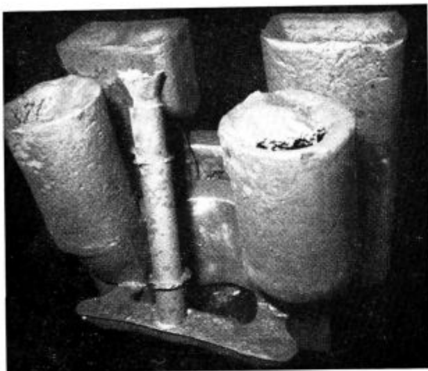
Teža vlivnega in napajalnega sistema 176 kg
