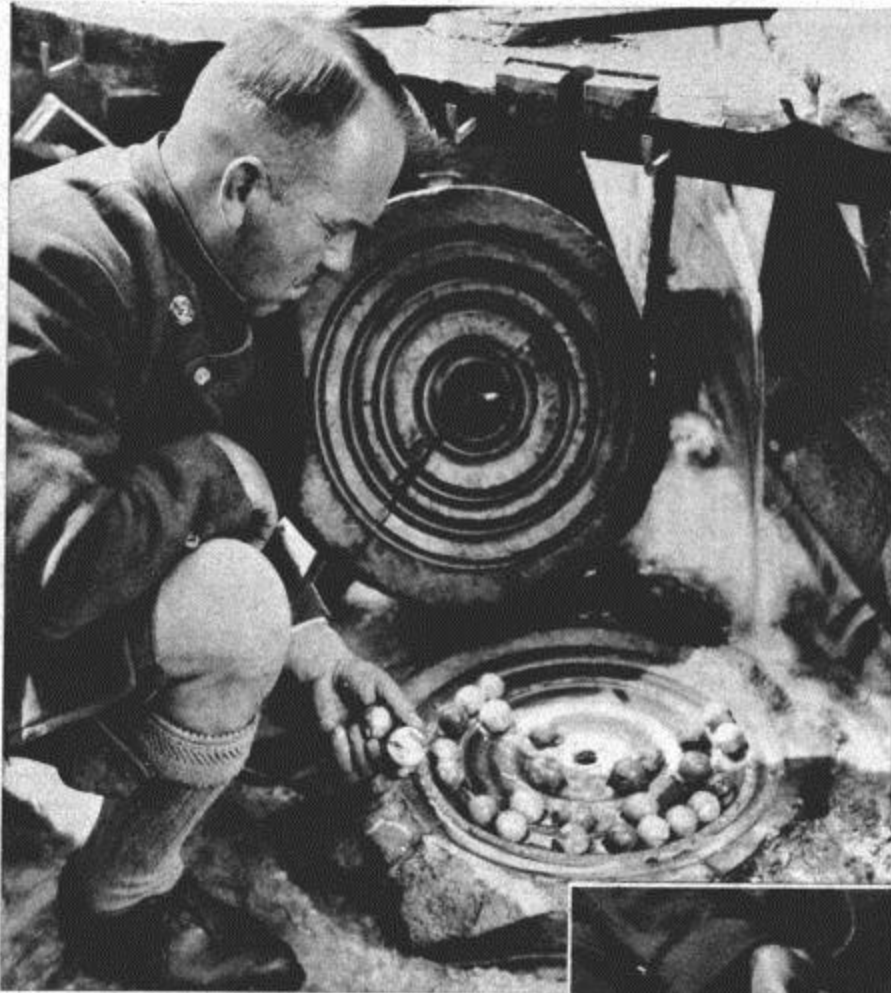
Der Kugelmüller hat eine der Mühlen aufgedeckt. Der obere Buchenholzdeckel mit den Turbinenschaufeln auf der Oberseite ist zurückgeschoben, so daß die Kugeln in den Rillen des Steinblocks zur Prüfung frei liegen
