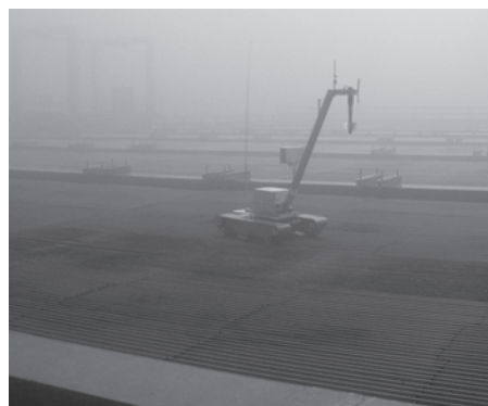
Sl. 1. Premična enota s krilnim anemometrom in Pt-100 termometrom v hladilnem stolpu jedrske elektrarne Doel - Belgija
