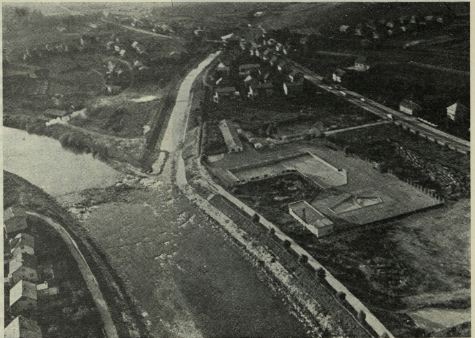
Sl. 5. Regulacija Savinje in Ložnice v Celju. Ureditev celjskega hidrosistema je osnovni pogoj za razvoj Celja. Savinja regulirana 8 km, Voglajna 5 km, Ložnica 1 km — se nadaljuje
