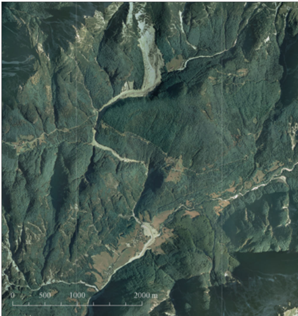
Slika 75: Plaz Stovžje (zgoraj), pot (na sredini) in vršaj drobirskega toka v Logu pod Mangartom (spodaj) (barvni ortofotografski posnetek, © Geodetska uprava Republike Slovenije 2005).
