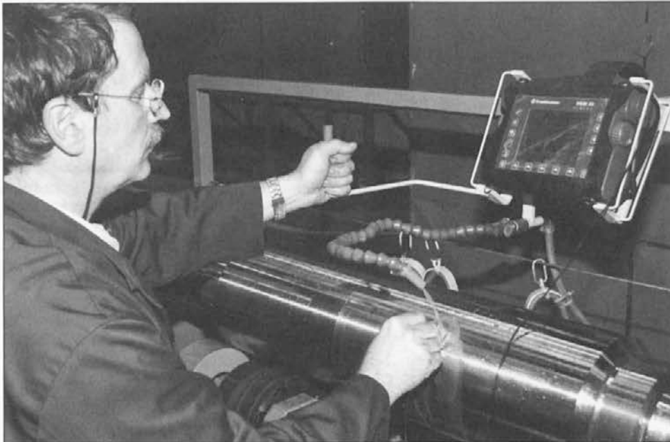
Ultrazvočna kontrola valjev
