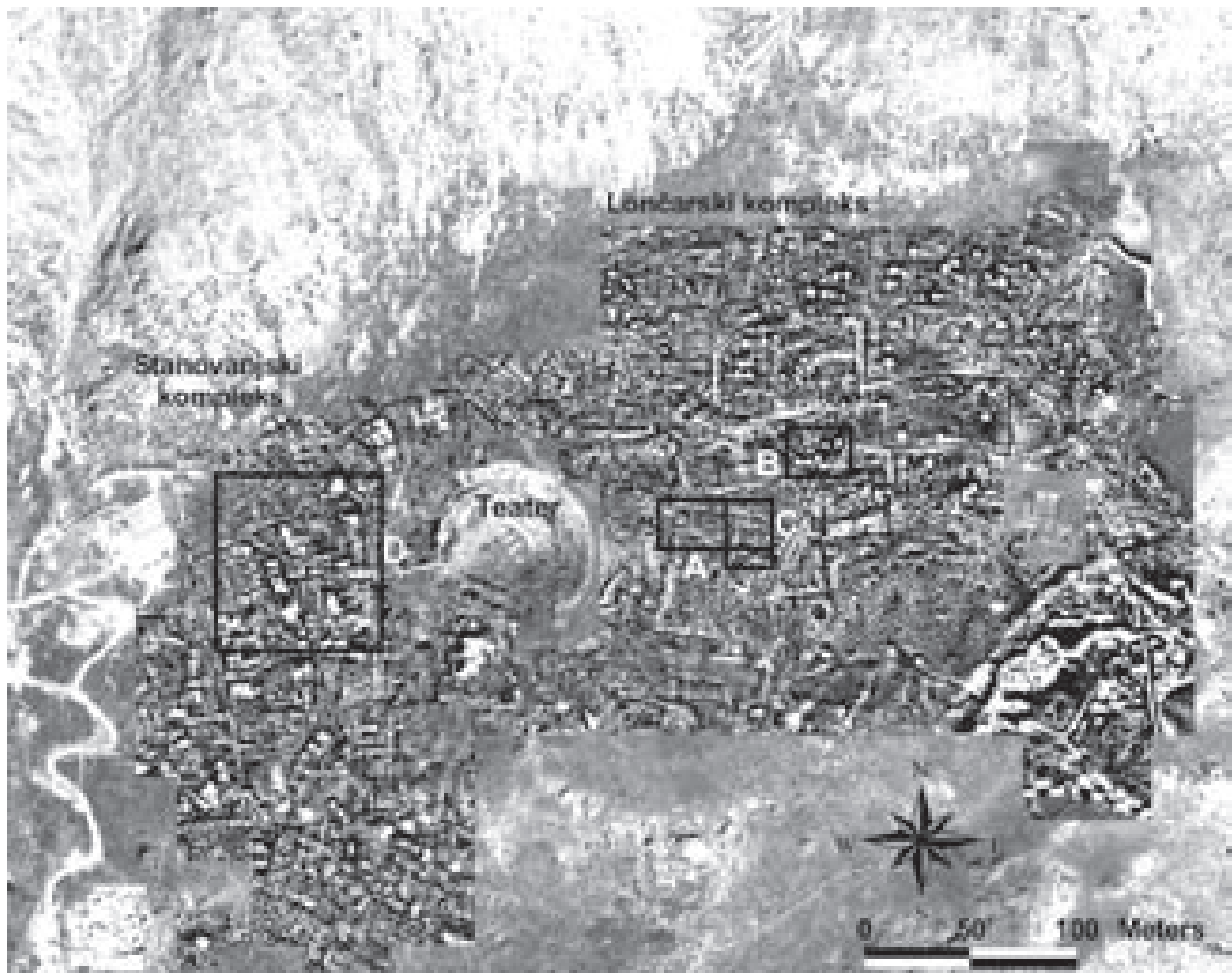
Sl. 6: Magnetogram vertikalnega gradienta gostote totalnega magnetnega pretoka. Označene so površine (A-D), ki so v članku podrobneje obravnavane. Položaj raziskane površine je označen na sliki 3.
