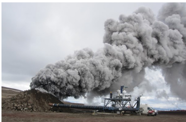
Sl. 9. Izlivalni poskus iz vrtine IDDP-1 v nov. 2011 pri temperaturi, ki se je dvignila do 450 °C. V prvih urah je bila para sive barve zaradi produktov korozije (FRIDLEIFSSON in sod., 2014; slika iz MARKUSSON & HAUSSON, 2015).
