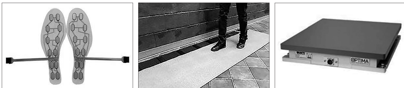
Slika 2: Sistemi za merjenje kinetike: vložki za čevlje – Fsrtek (levo) (15), pohodna podlaga – GAITRite (16) (sredina), pritiskovna plošča AMTI (17) (desno).
