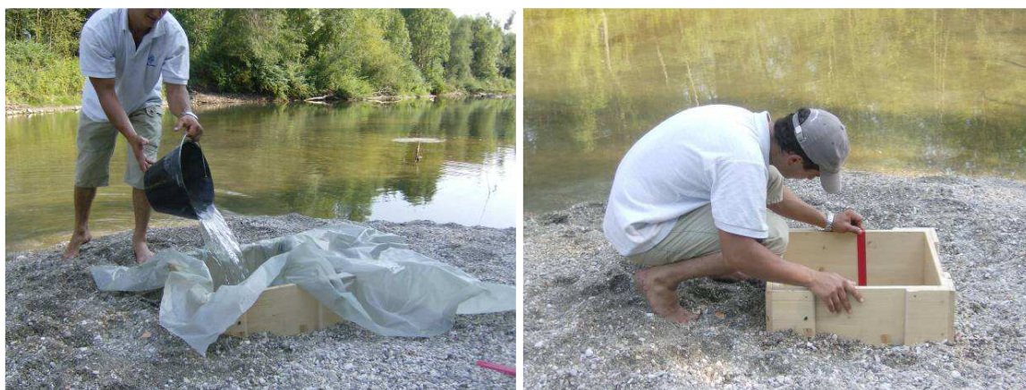
Slika 10 - Polnjenje zakopanega škatlastega okvirja (levo) in meritev infiltracije (desno) (foto: Lunka, 1. 8. 2009)
