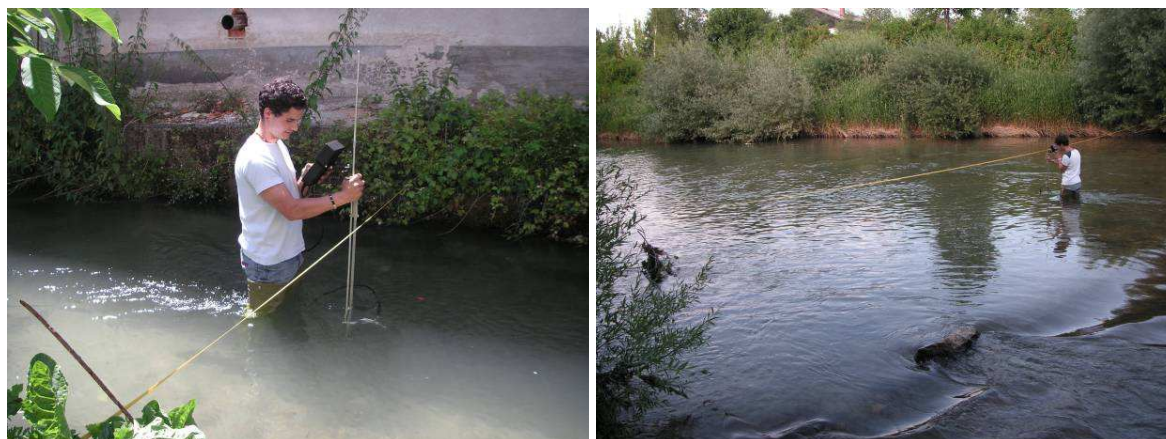
Slika 8 - Meritev pretokov na Homški mlinščici (levo) in meritev pretokov na Kamniški Bistrici (desno) (foto: Lunka, 6. 2009)
