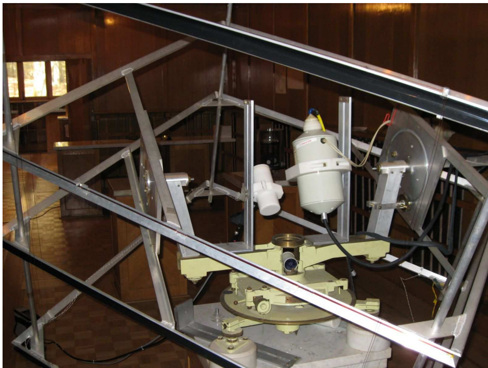
Slika 2: Kalijev protonski magnetometer na optično vzbujanje z izotopom 39 K (desno) in merilna sonda Overhouserjevega protonskega magnetometra (levo) v homogenem polju sistema tuljav
