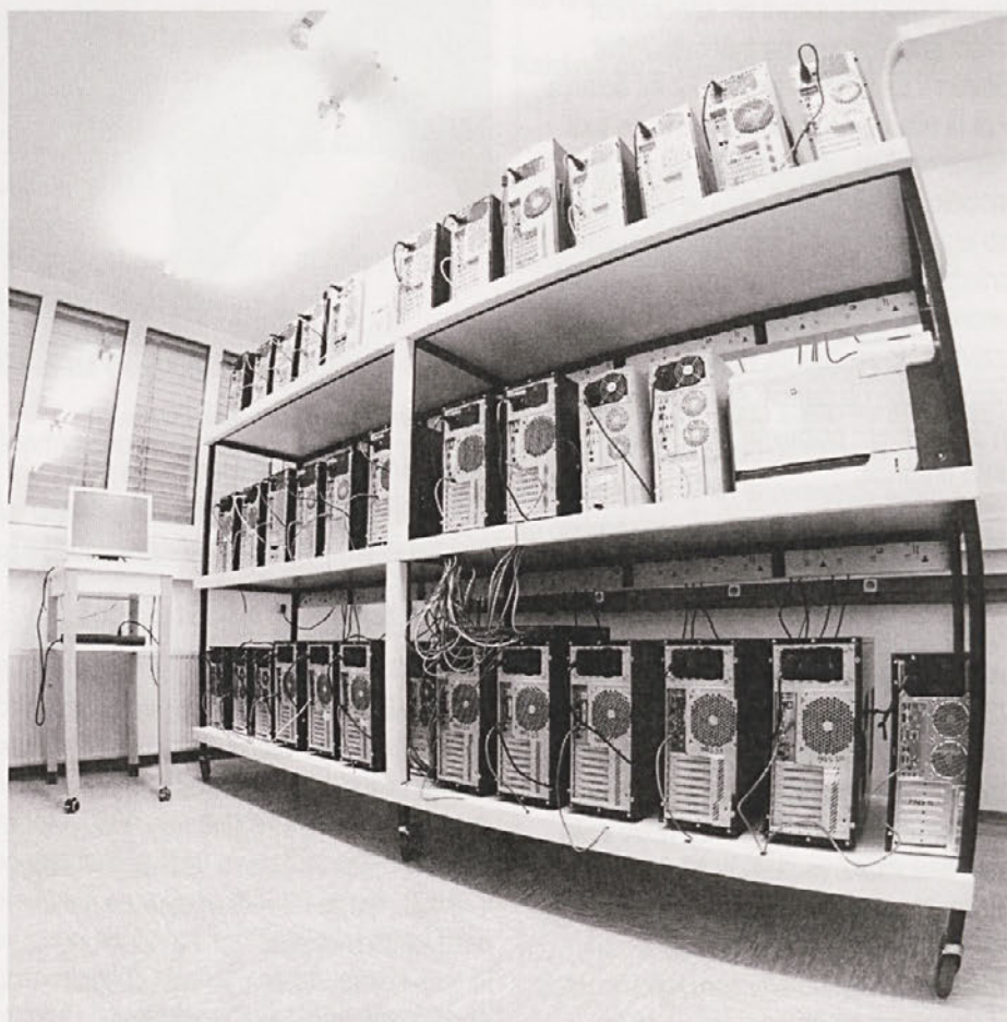
Superračunalnik PARS Odseka za fizikalno in organsko kemijo na Institutu Jožef Stefan. 330 procesorjev +1 TB RAM, poraba energije pri polni obremenjenosti 9 kW. Foto: Sebastijan Peljhan
