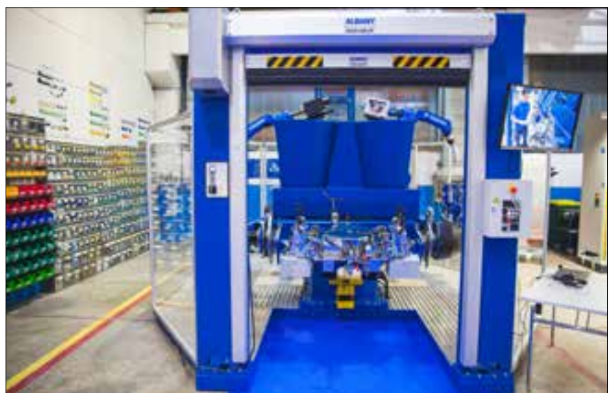
Robotska varilna celica z industrijskima robotoma Motoman, pritrjenima na dvo položajno pozicionirno mizo
