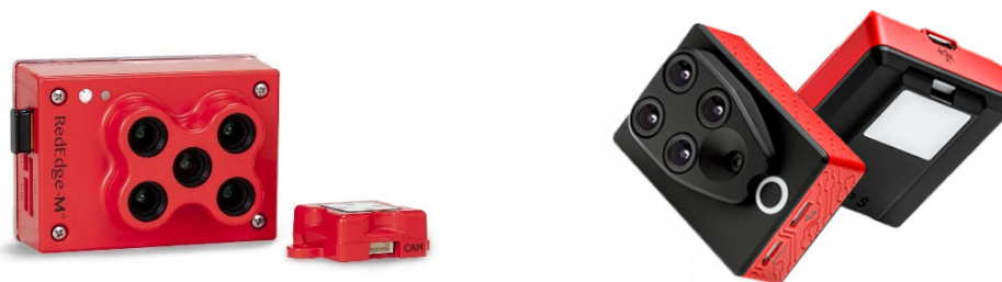
Slika 20: Uporabljeni multispektralni kameri MicaSense (levo) in Parrot Sequoia (desno). MicaSense snema v petih delih spektra: modri, zeleni, rdeči, NIR in red edge in s prostorsko ločljivostjo reda velikosti nekaj centimetrov (odvisno od višine leta). Parrot Sequoia je podobnih lastnosti kot MicaSense, le da ne ponuja modrega slikovnega kanala. Obe kameri omogočata kalibracijo slik glede na svetlobne razmere ter beleženje lokacije posnetka z vgrajenim GPS (foto MicaSense, Parrot).
