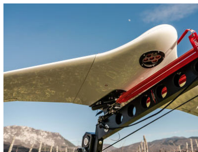
Slika 18: Brezpilotni krilati letalnik C-astral Bramor in pripadajoči katapult za izstrelitev (foto C-astral).
