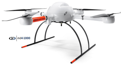
Slika 17: Ortokopter MD4-1000 proizvajalca Microdrones GmbH (foto Microdrones).
