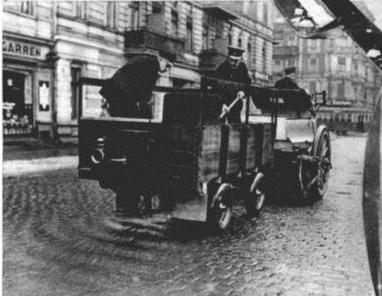
Kampf dem Matsis. Ein kreisendes Rad streut den im Wagen aufgespeicherten Sand fein verteilt über die halbe Straßenbreite, so daß der großstädtische Damm dem Verkehr wieder gewachsen ist. K.
