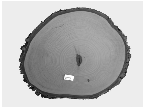
Sl. 8.12: Prečni prerez jesenovega debla. Osrednjemu delu, ki je na sliki temno obarvan in razpokan, so se pri izdelavi kolesa izognili, saj praviloma vsebuje les slabših lastnosti. Foto: M. Zupančič.
