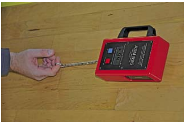
Slika 2: Prikaz meritve in merskega pripomočka za merjenje drsnosti športnega poda
