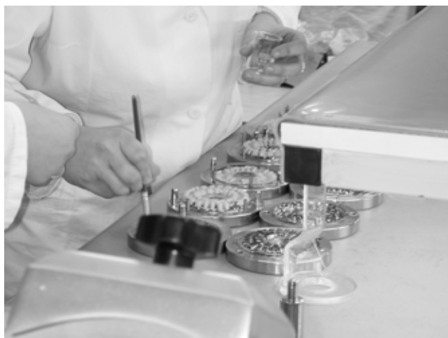
Slika 3: Matrice iz elektrolitskega niklja, ki smo jih zaščitili z nizkotemperaturno CrN-prevleko, v proizvodnji zob iz polimetilmetakrilata (PMM) v podjetju Polident (Volčja Draga pri Novi Gorici)
