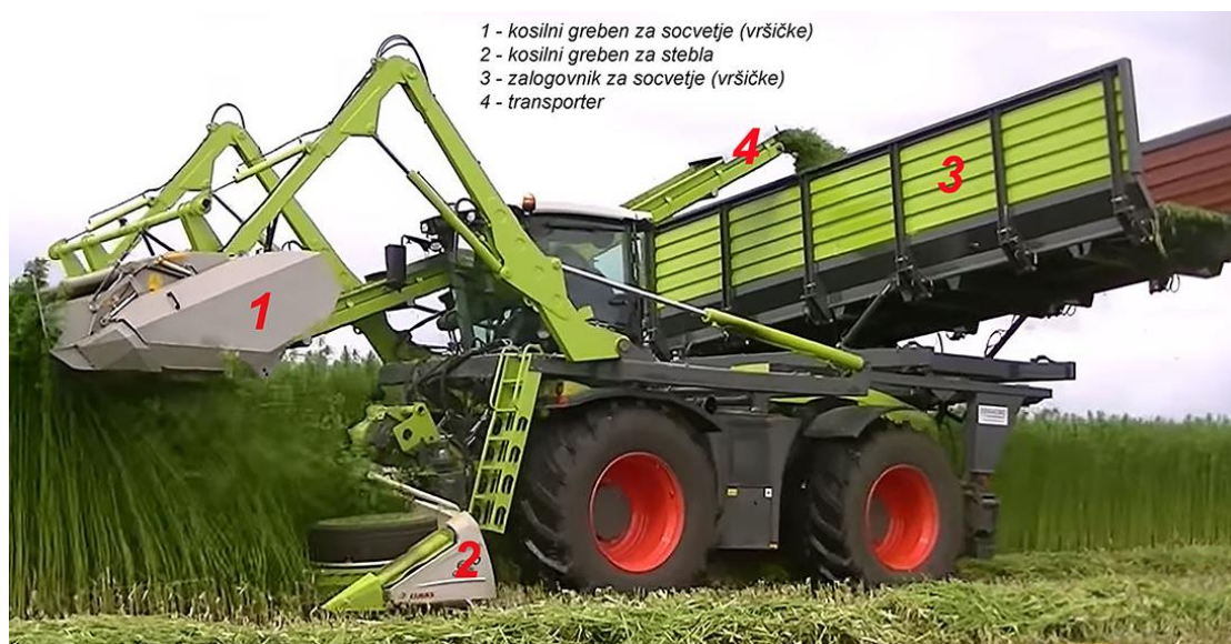
Slika H2: Namensko izdelani kombajn za žetev industrijske konoplje Hemp-flax; (12. junij 2017).
