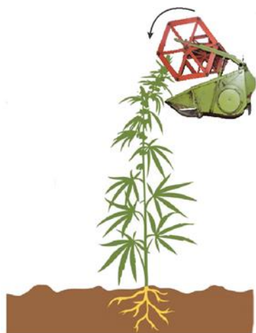
Slika H10: Kosilni greben in motovilo na primerni višini
