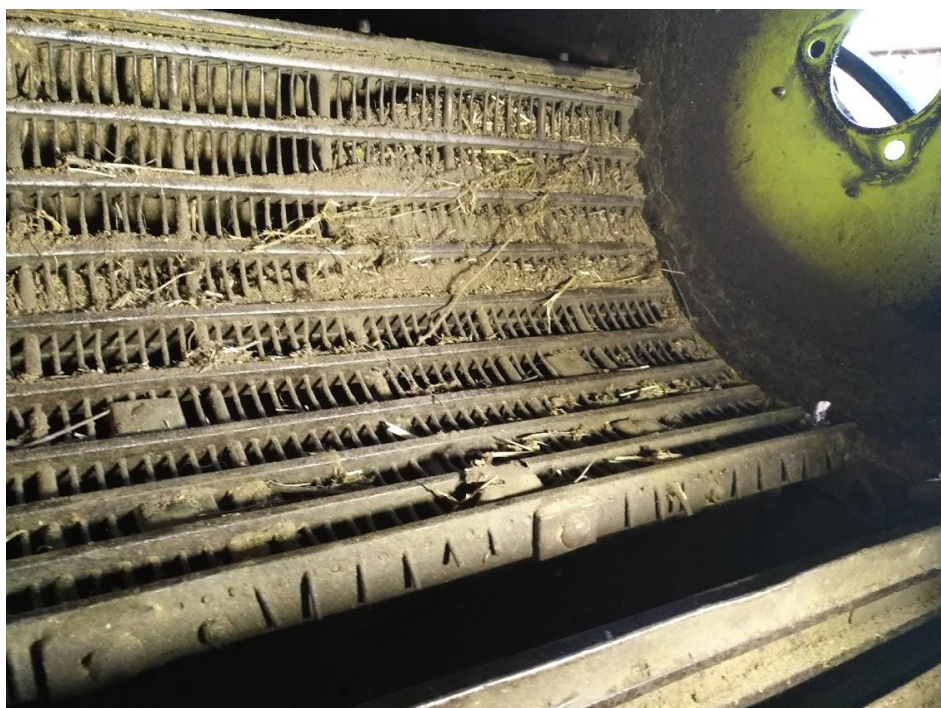
Slika H1: Delno zamašeno sito pod bobnom mlatilnice.
