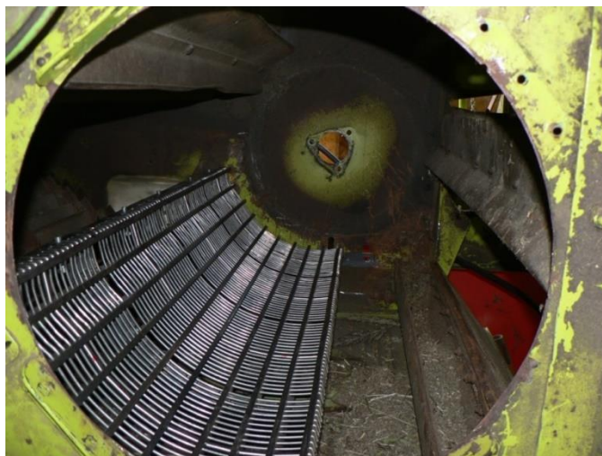
Slika H8: Končna montaža sita (kletke) v mlatilnico kombajna.
