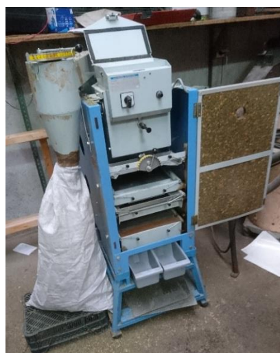
Slika B10: Čiščenje vzorcev semena na stroju sample cleaner model SLN3
