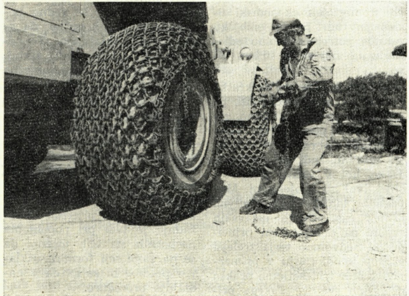
Montaža zaščitnih verig na delovni stroj
