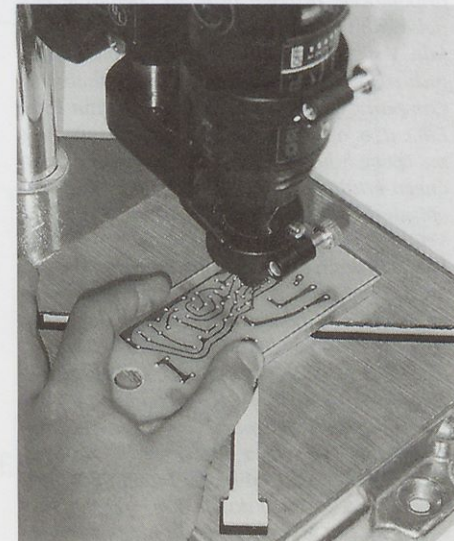
Slika 5. Ker so možnosti za uporabo takšnega stojala (z nekoliko iznajdljivosti ob izdelavi pomožnih šablon) skoraj neomejene, bi ga moral imeti v svoji delavnici vsak modelar ali maketar. Na sliki je vrtanje lukenj v ploščico tiskanega vezja.
