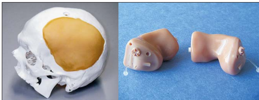
Slika 3. Primer izdelave lobanjskega vsadka in slušnega aparata, narejenih po meri za znanega kupca z uporabo stereolitografije
