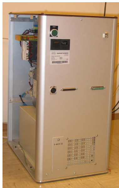
Slika 2.2: Skupno ohišje krmilnega računalnika in močnostnih ojačevalnikov
