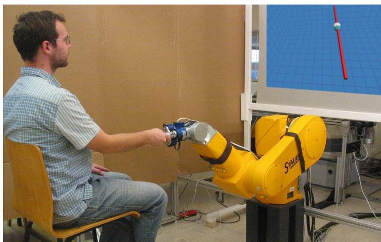
Slika 1.7: Robot Staubli RX90, uporabljen kot haptični vmesnik
