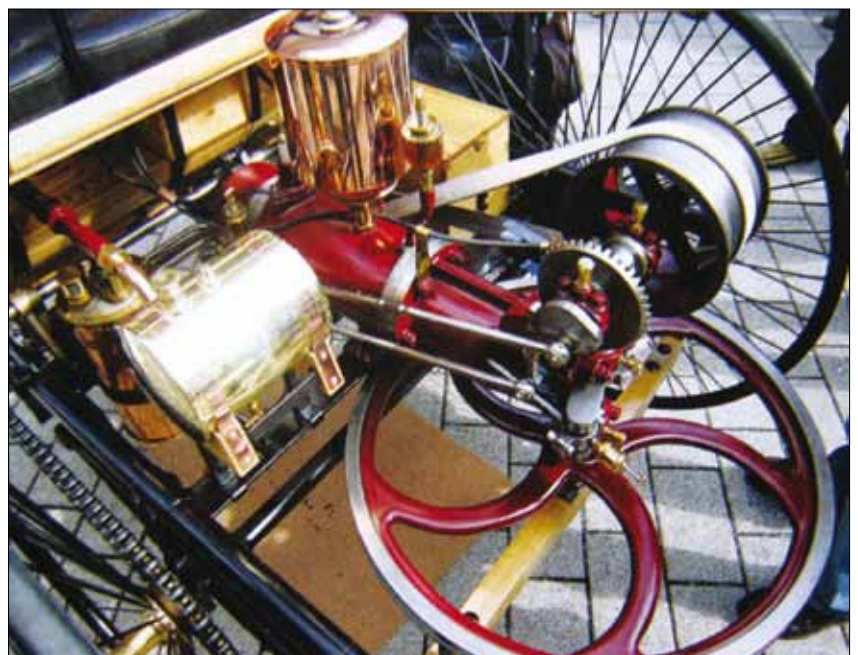
Obnovljen motor na notranje izgorevanje pri Benzovem vozilu kočiji
