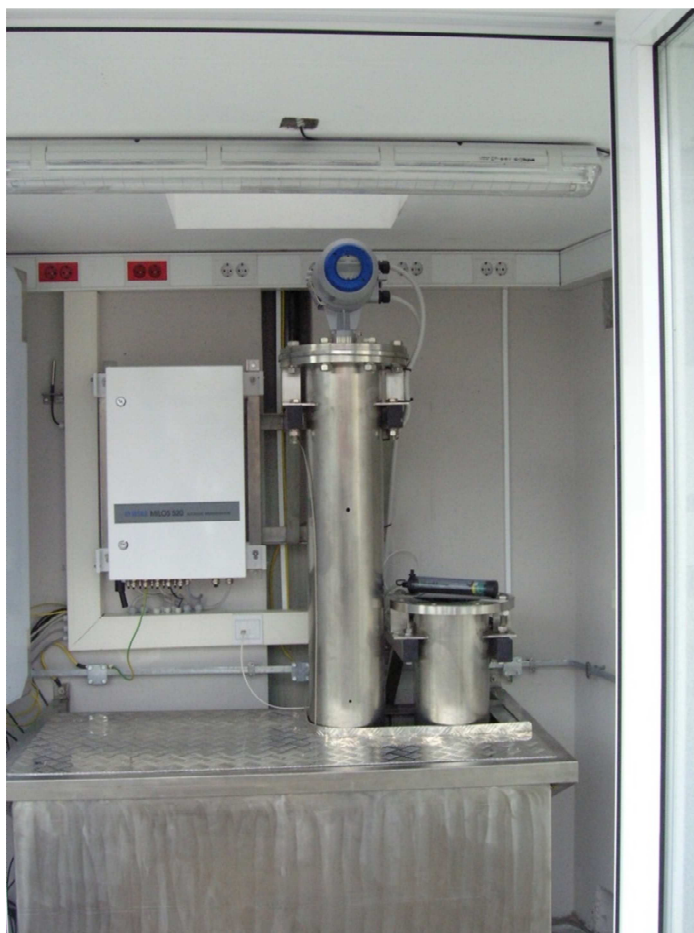
Slika 3 - Radarski senzor in senzor s plovcem na MP Koper
