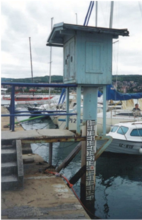
Slika 1 - Stari mareograf v Kopru in skica principa delovanja mehanskega mareografa
