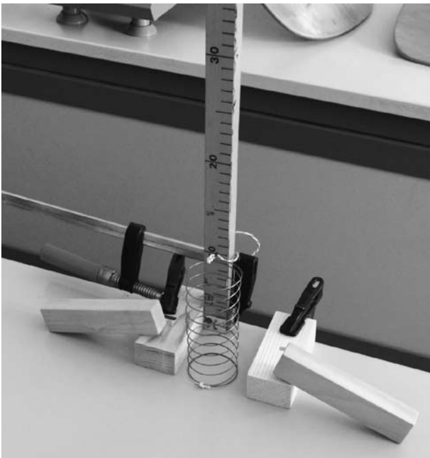
Slika 5. Spodnji pritrjeni deščici omogočata, da vzmet pri vseh poskusih enako stisnemo. Zgornji deščici pa omogočata, da vzmet sunkovito sprostimo, tako da odskoči. Višino premika težišča preberemo s pokončnega ravnila, ko proučujemo posnetek poskusov.
