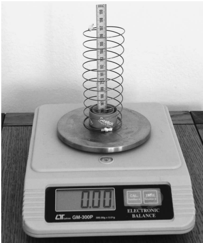
Slika 3. Vzmet in del metra, ki je pritrjen na nosilec lepilnega traku, sta na tarirani tehtnici. Vzmet stiskamo z vodoravno palico in hkrati zapisujemo maso, ki jo kaže tehtnica, ter skrček vzmeti.
