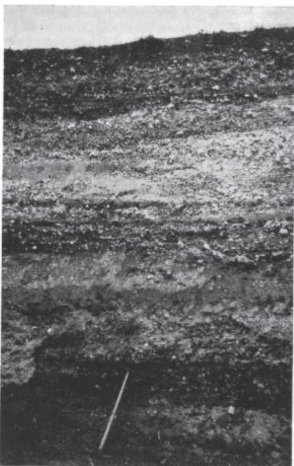
Sl. 41. Prerez v vršajskem gradivu »Cerkljanske« Reke. Menjava različno zrnatih plasti kaže na zelo neenakomerno nastajanje vršaja. Spodnja plast proda na sliki je že deloma sprijeta; konglomeratni vložki so tudi v višjih plasteh vršaja. Sedimentacija je dobro vidna
