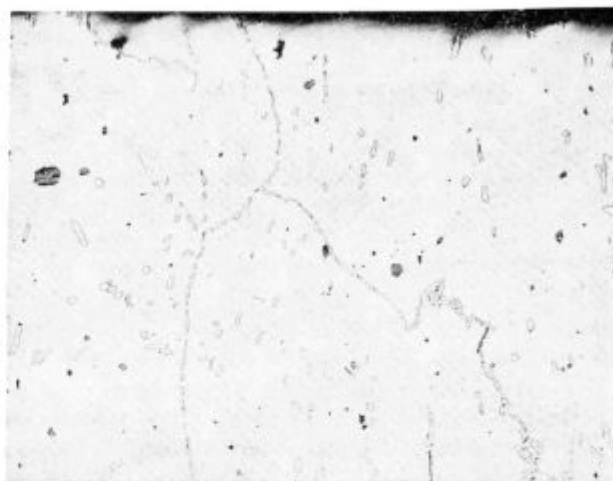
Slika 4 Ferit in kromovi karbidi — 100 x
