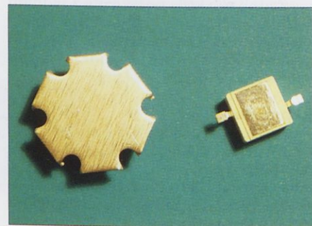
Zadnja stran LED-diode je izvedena podobno kot močnostni polvodniki. Hlajenje diode je tako bolj učinkovito.
