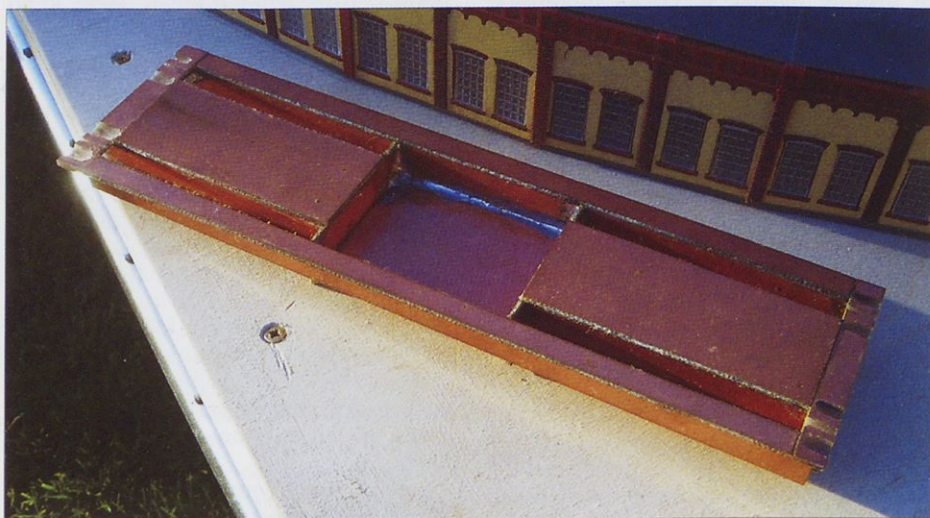
Talne plošče morajo biti prispajkane v isti višini.
