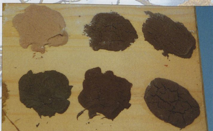
Mavcu podobna masa s primešanimi akrilnimi barvami; če dodamo več barve, je površina bolj razpokana.
