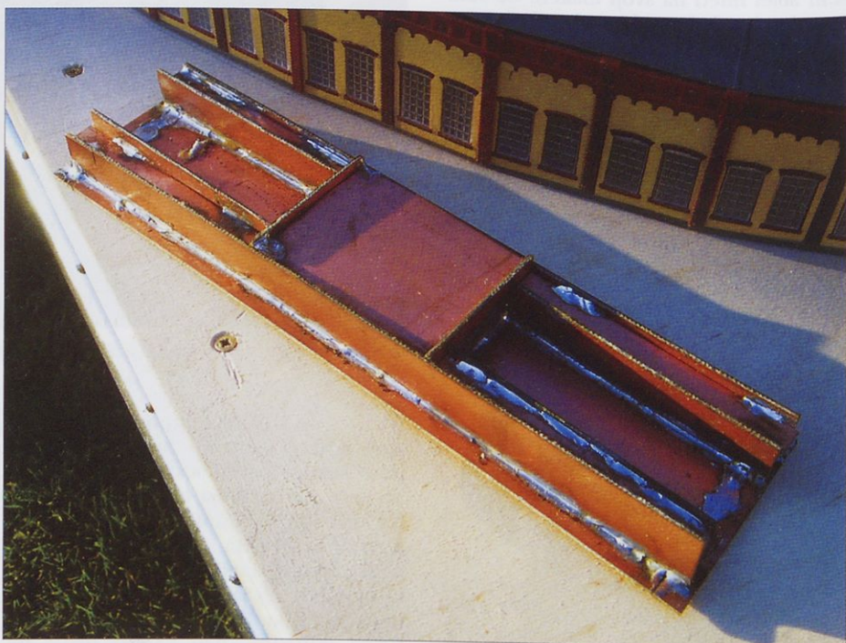
Bakreno površino sem rahlo prebrusil, da se je spajka lepo prijela. Pomagal sem si tudi s pasto za spajkanje.
