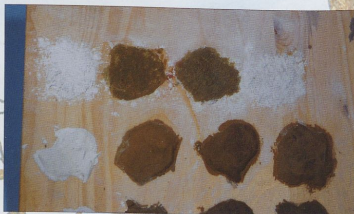
V spodnji vrsti je mavec s primešanim akrilnim lakom, v zgornji pa mavec, potresen po mokrem laku in pokapan z vodo.
