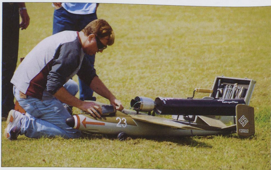
Thomas Geissinger pripravlja model letala heinkel He-162, ki ga poganja reakcijska turbina. Model je dosegel hitrost 300 km/h.
