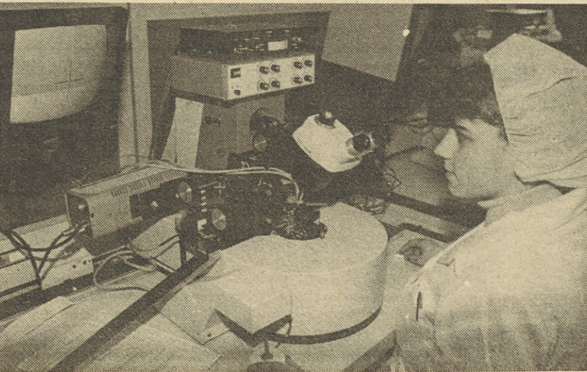
Dunja Pecherv v Mikroelektroniki avtomatsko bondira monolite.
